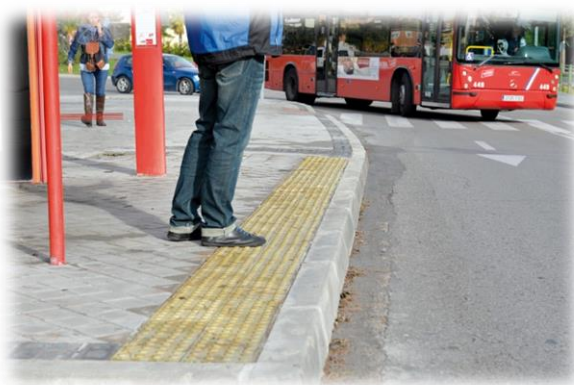
Figura 35. Ejemplo de parada de autobús accesible según RD 1544/2007.
